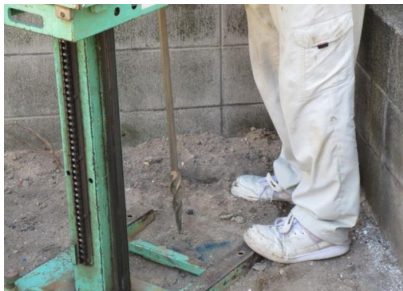
（参考写真：スウェーデン式サウンディング試験の様子）
